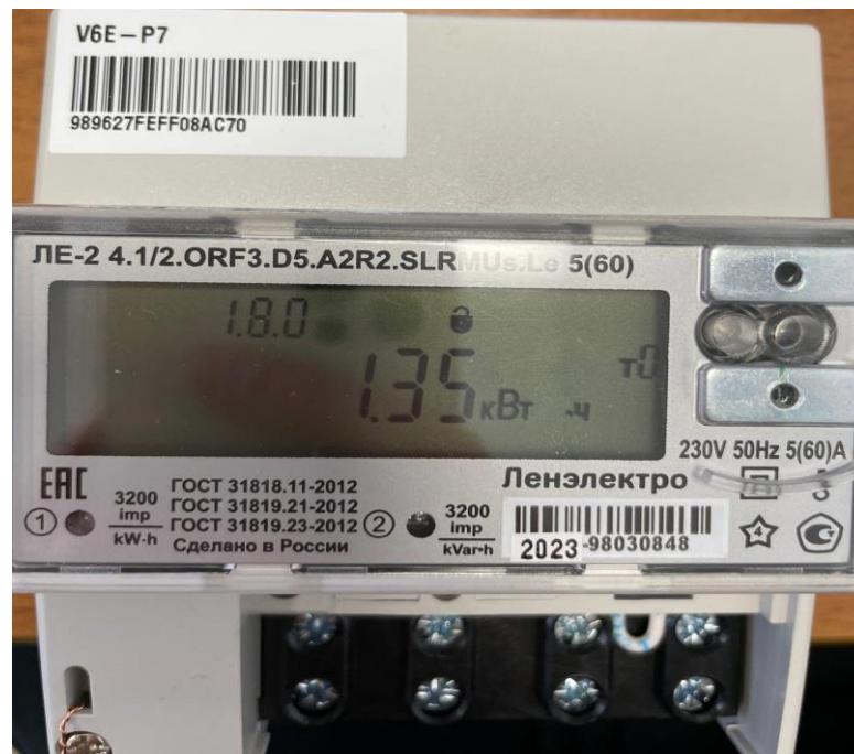
Рис.3 Отображение суммы всех показаний Тсумм – обозначается кодом 1.8.0 в верхнем левом углу экрана.
