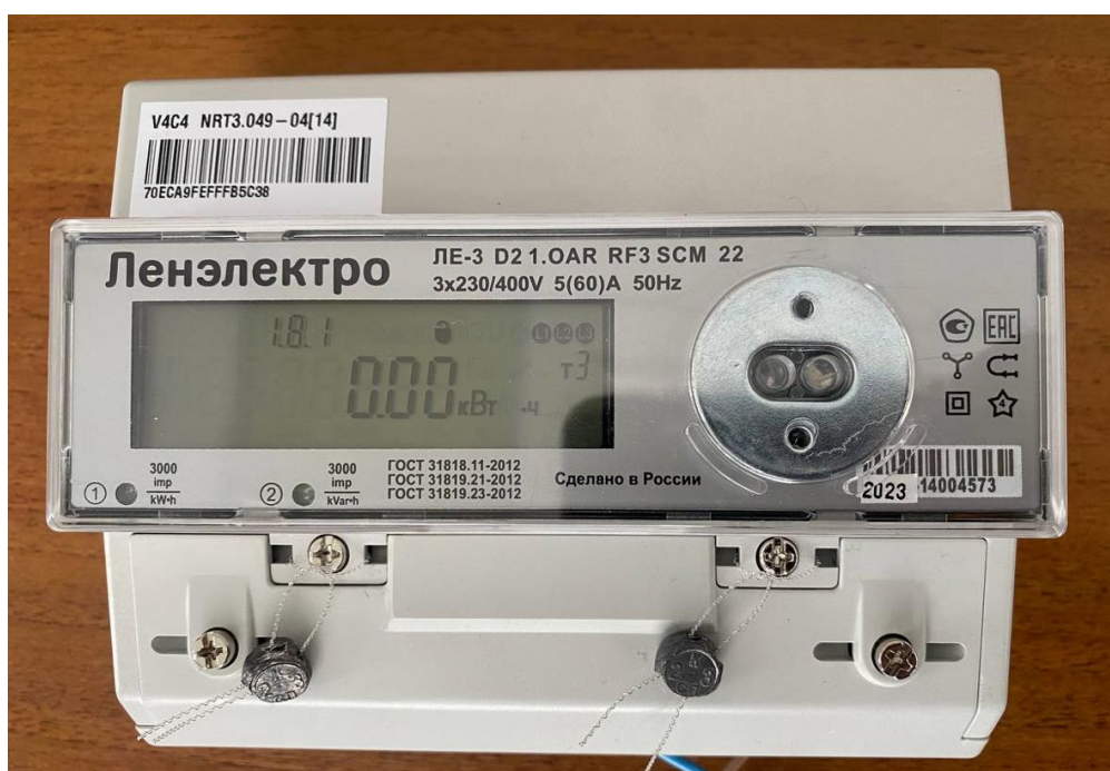
Рис.4 Отображение показаний по Т1 – обозначается кодом 1.8.1 в верхнем левом углу экрана.
