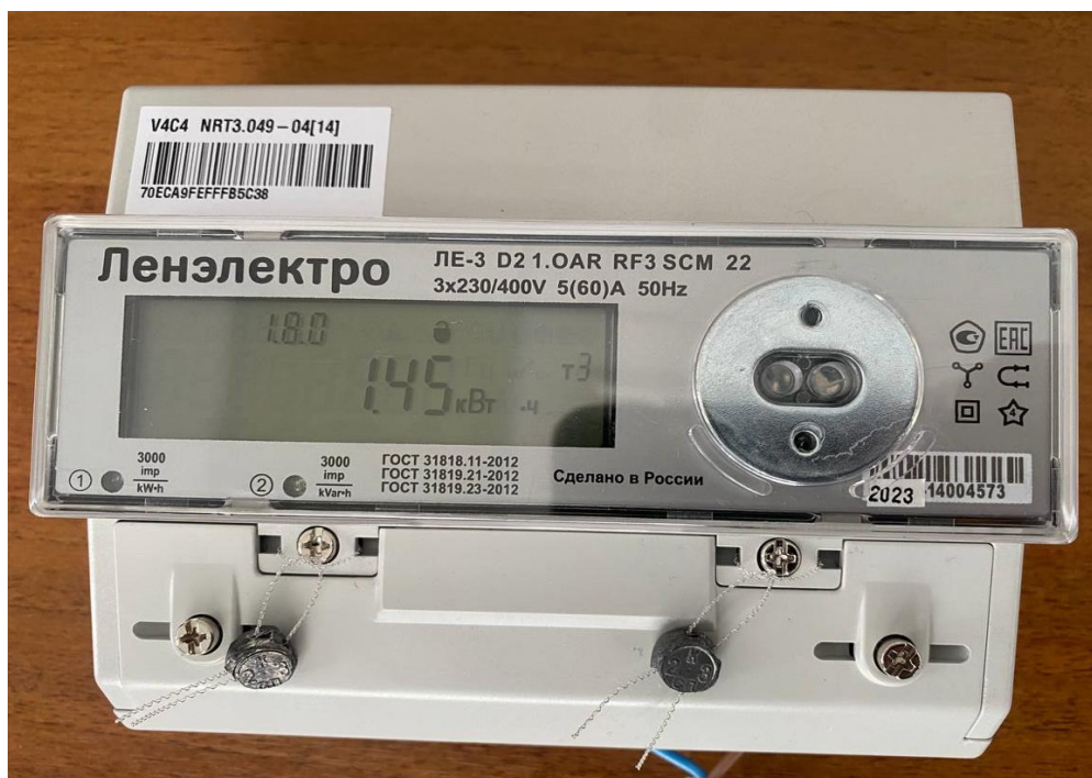
Рис.3 Отображение суммы всех показаний Тсумм – обозначается кодом 1.8.0 в верхнем левом углу экрана.
